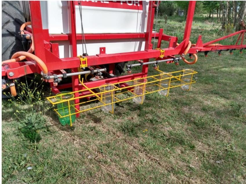
Figura 2. Soporte metálico para 5 botellas de 2 litros plásticas descartables.
