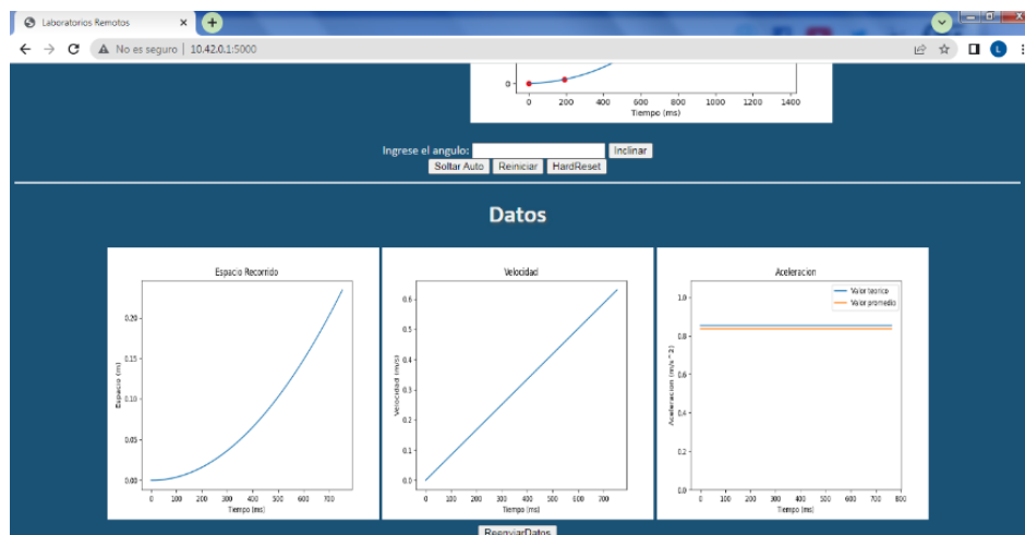
Figura 9. Imagen de la interfaz gráfica de usuario (vista de las curvas de espacio, velocidad y aceleración obtenidas).
